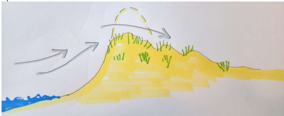
Figuur 3.5: Principe van verstuiving in de zeereep in doorsnede. Op Vlieland is de zeereep over grote lengte smal en hoog (situatie a) bovenste figuur). Door bijvoorbeeld de top er af te schuiven of een kerf te maken zal zand naar binnen gaan stuiven (situatie b) onderste figuur). De zeereep wordt dan breder en robuuster. Zand dat eerder in situatie a) niet verder het eiland op kon, kan dat in situatie b) wel. Het totale volume aan zand dat op het eiland blijft wordt dan groter.
