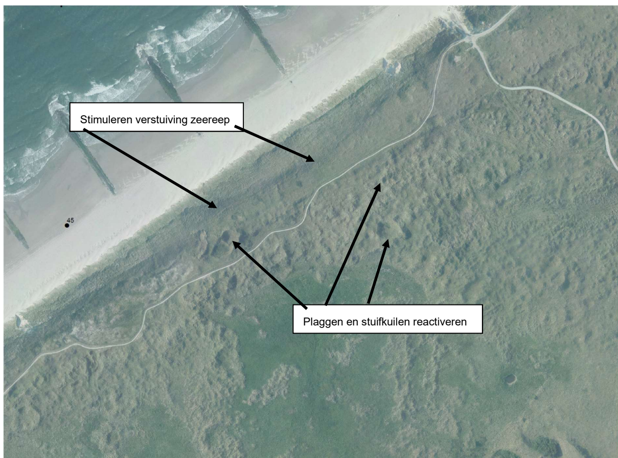
Figuur 4.4: In de zone tussen de zeereep en het Oude Huizen Lid is het de bedoeling om een reeks kerven en stuifkuilen te activeren (zie ook figuur 4.3 en 4.5).
